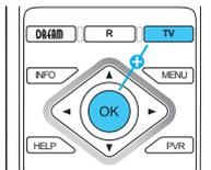
2. Geben Sie 888 über die Zehner-Tastatur ein um den Lernmodus zu aktivieren. Die blaue Tastenbeleuchtung geht aus und die TV-Steuerung-Taste leuchtet dauerhaft rot.
