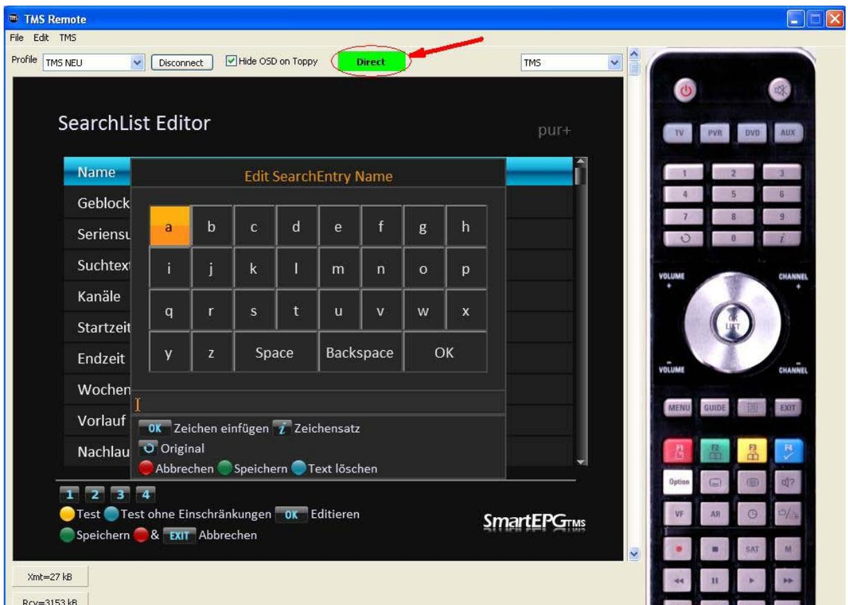
Wenn man den Haken bei „Hide OSD on Toppo“ setzt, wird in der Sicht Guide und Overview1 das TV Bild nicht verkleinert und das Scrollen der erweiterten Infos abgeschaltet.
