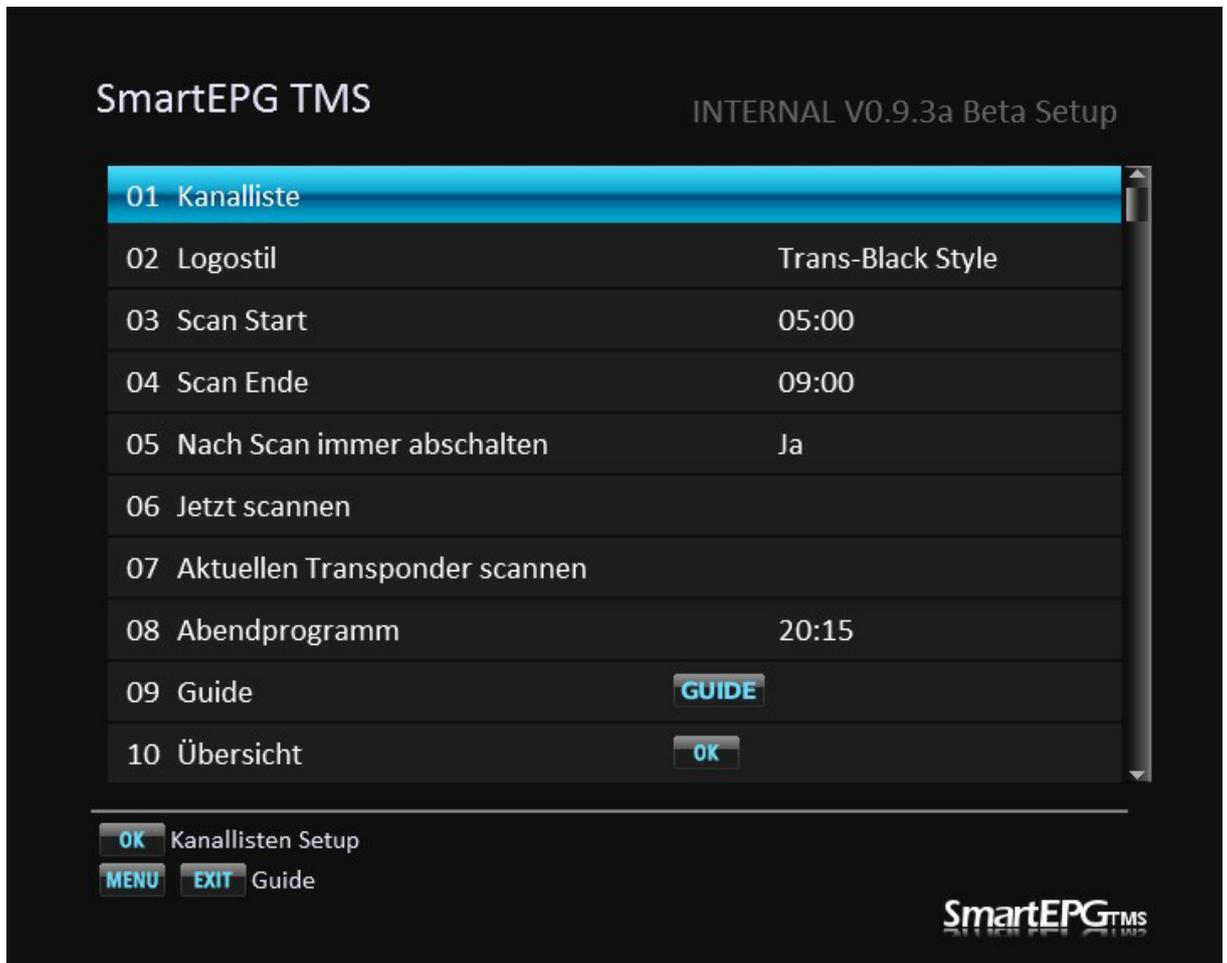
**01 Kanalliste:** hier wird eingestellt, welche Kanäle gescannt werden sollen. Werden Änderungen vorgenommen, erfolgt beim Verlassen dieses Menüs ein Neuaufbau der EPG-Datenbank. Sender, die auf einem Transponder liegen, der bisher noch nicht gescannt wurde, zeigen EPG-Daten aber erst nach dem nächsten manuellen oder automatischen Scan.
